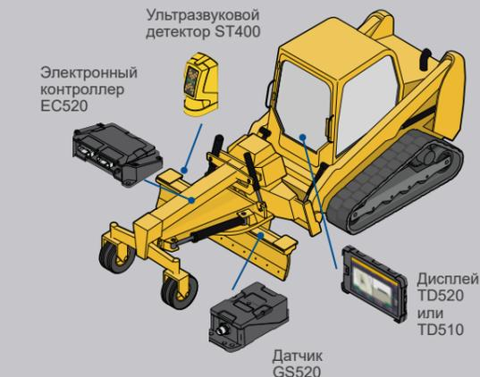
Система Trimble Earthworks для грунтовых катков помогает операторам производить уплотнение грунта по более эффективной схеме за нужное количество проходов, чтобы быстрее добиться нужной плотности грунта, независимо от квалификации оператора. Операционная система нового поколения на платформе Android™ и большой удобный сенсорный дисплей позволяют наблюдать за процессом уплотнения грунта, подсчитывать проходы, а также выводить на экран и регистрировать жесткость уплотненного грунта.
