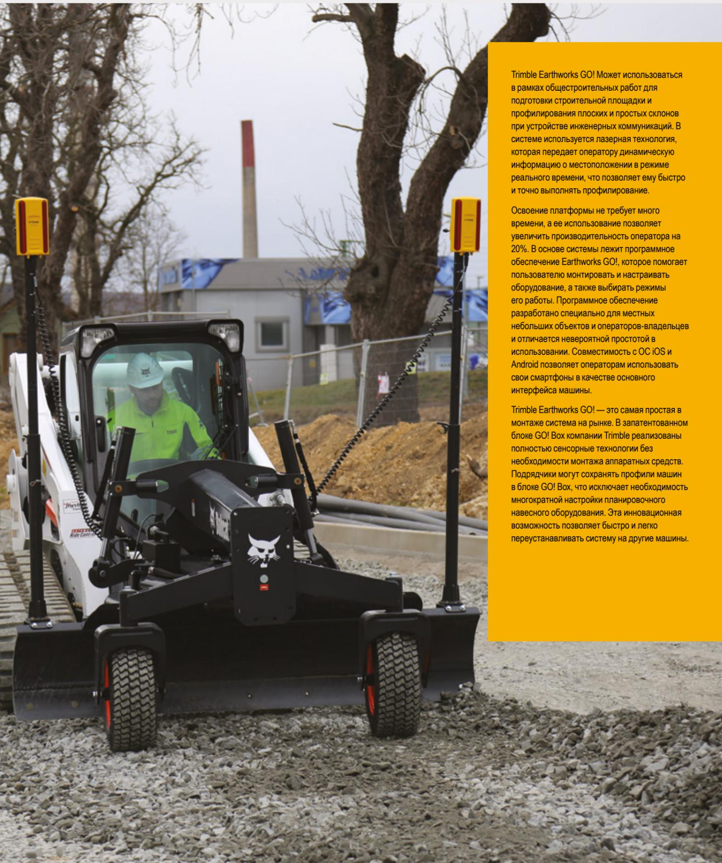
Trimble Earthworks GO! Может использоваться в рамках общестроительных работ для подготовки строительной площадки и профилирования плоских и простых склонов при устройстве инженерных коммуникаций. В системе используется лазерная технология, которая передает оператору динамическую информацию о местоположении в режиме реального времени, что позволяет ему быстро и точно выполнять профилирование.
