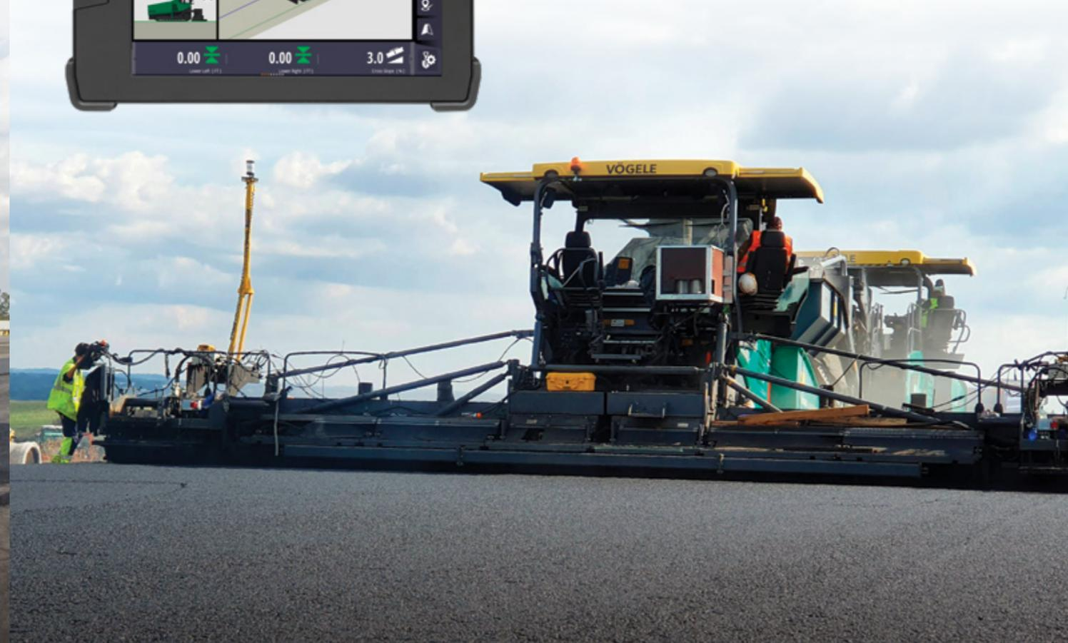
Платформа контроля за укладкой дорожного полотна для асфальтовых катков Trimble Roadworks представляет собой интеллектуальную систему нового поколения, которая помогает операторам оптимизировать скорость, точность и трудоемкость уплотнения асфальта, независимо от квалификации оператора.
